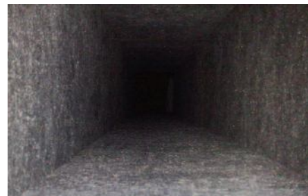
Climacoustic después de someterlo a 20 ciclos de limpieza
